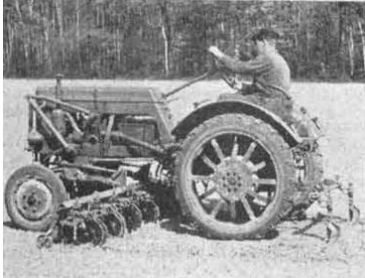
Kleinschlepper mit zwischen Vorder- und Hinterachse angebautes Hackgerät
