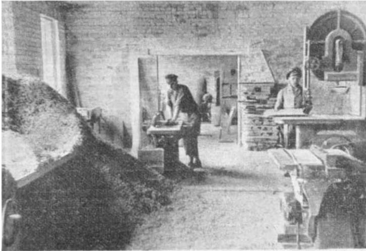
**Bandsäge, Abrichte, Fräse und Hobelmaschine sind die wichtigsten Holzbearbeitungsmaschinen. Hier arbeitet der Meister zusammen mit seinem Sohn.**
